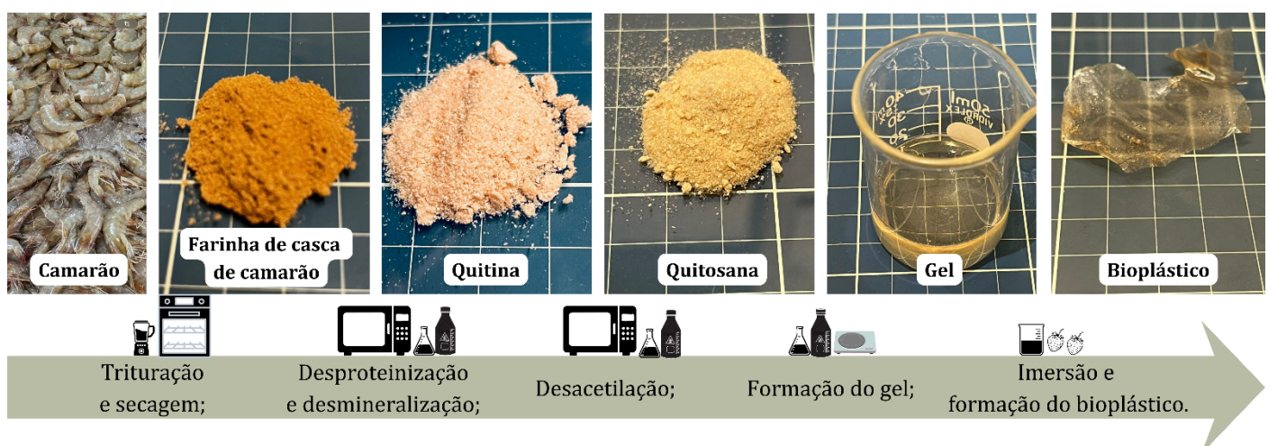
Figura 1 – Fluxograma de processamento para transformação da casca de camarão em gel de quitosana ou bioplástico.
